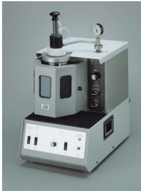
Şekil 4.1. Örneklerin üretilmesinde kullanılan ark fırını.
