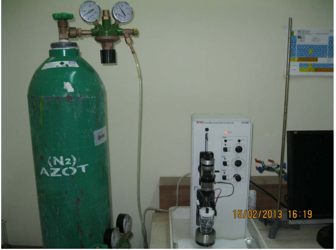
Resim 4.2. Azot gazı ile çalışan asılı damla civa elektrot sistemi
