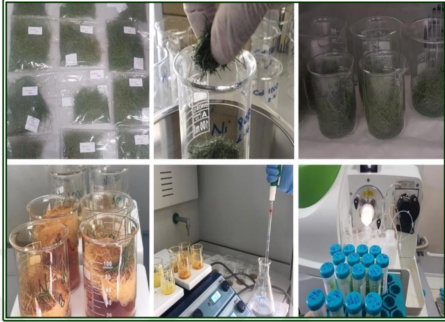
Resim 5.7. Bitki örneklerinde ağır metal analizleri için yapılan ön çözme işlemleri
