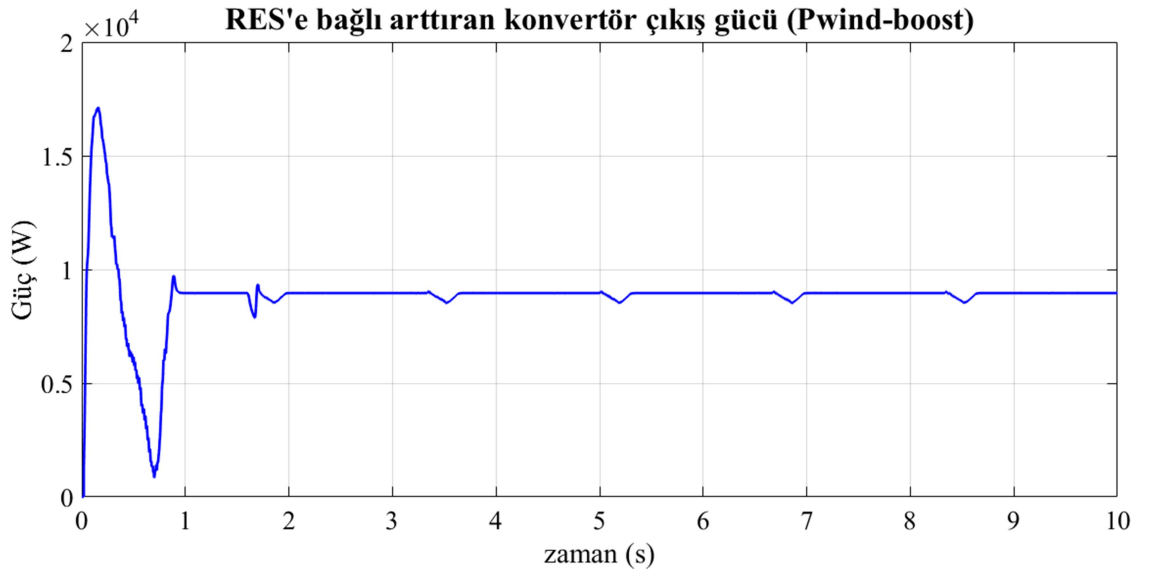
Şekil 5.7. Arttıran konvertör çıkış güç eğrileri, (a) GES'e bağlı arttıran konvertör çıkış gücü (Ppv_boost), (b) yakıt hücresine bağlı arttıran konvertör çıkış gücü (Pfc_boost), (c) RES'e bağlı arttıran konvertör çıkış gücü (Pwind_boost)
