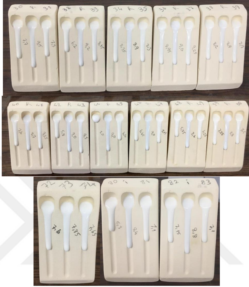
Resim 5.1. Fiziksel akma boyu ölçüm numuneleri.
