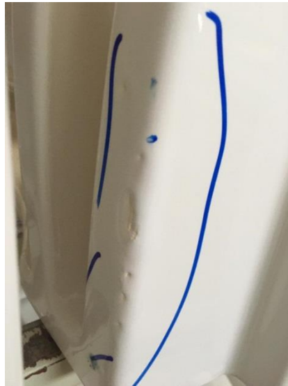
Resim 3.8. Sır Yüzey Hatası.
