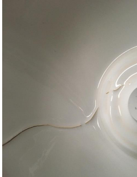
Resim 3.13. Sır Çatlağı Hatası.
