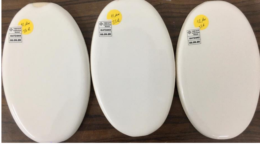
Resim 5.5. Pürüzlülük ölçümü yapılan R33 reçetesi.
