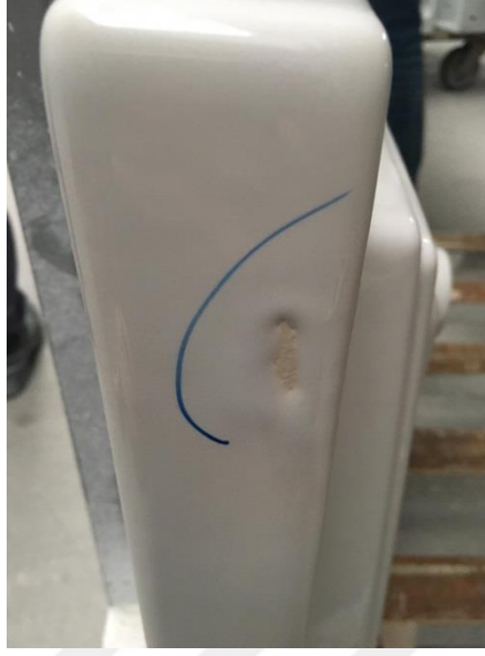
Resim 3.11. Sır Toplanması Hatası.
