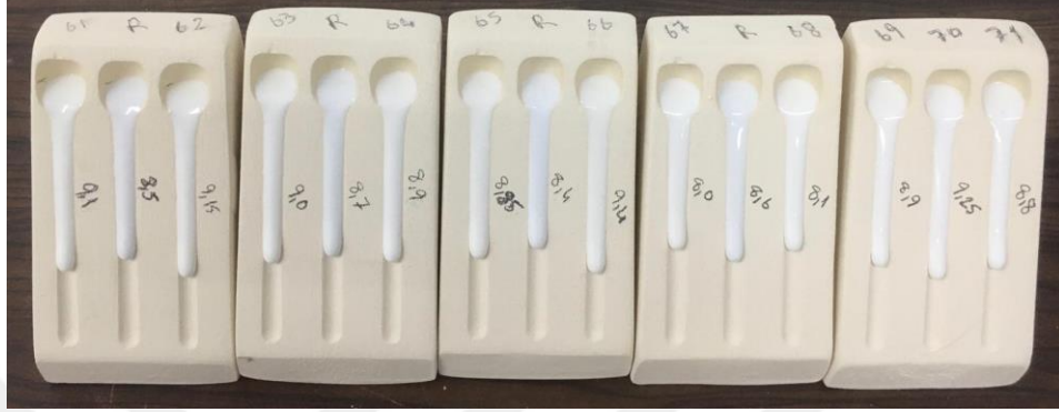
Resim 5.39. Fiziksel akma boyu ölçüm numuneleri.
