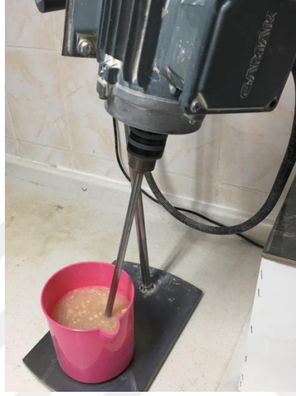
Resim 3.1. Toz halindeki karboksi metil selüloz maddesinin suda çözündürülmesi.
