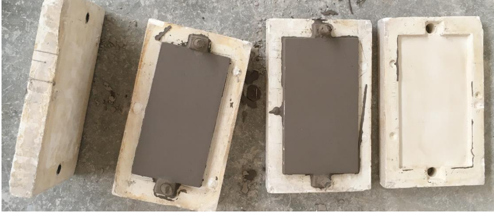
Resim 4.1. Dökümü yapılan FFC çamur bünye.
