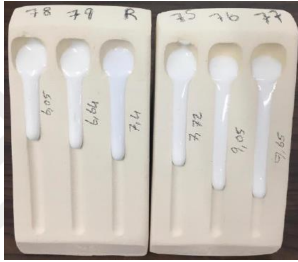
Resim 5.33. Fiziksel akma boyu ölçüm görseli.
