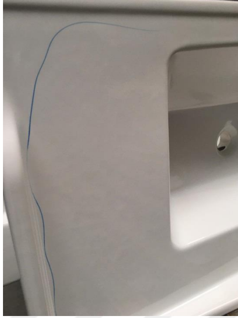
Resim 3.7. Düzgün Olmayan Sır Yüzeyi.
