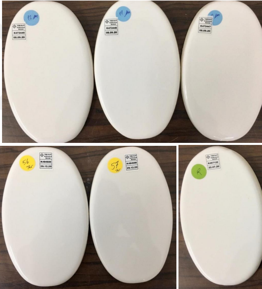
Resim 5.4. Pürüzlülük ölçümü yapılan sırlı seramik ürünler.
