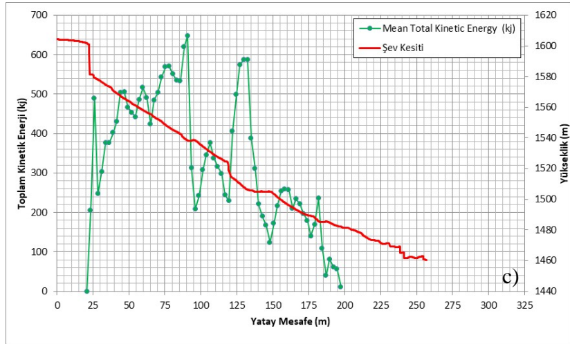
Şekil 4.17. a) Kesit-6 sıçrama yüksekliği dağılım grafiği b) Kesit-6 için şev yüzeyi sıçrama yüksekliği grafiği c) Kesit-6 şev yüzeyi toplam kinetik enerji grafiği d) Kesit-6 şev yüzeyi ötelenme hızı grafiği
