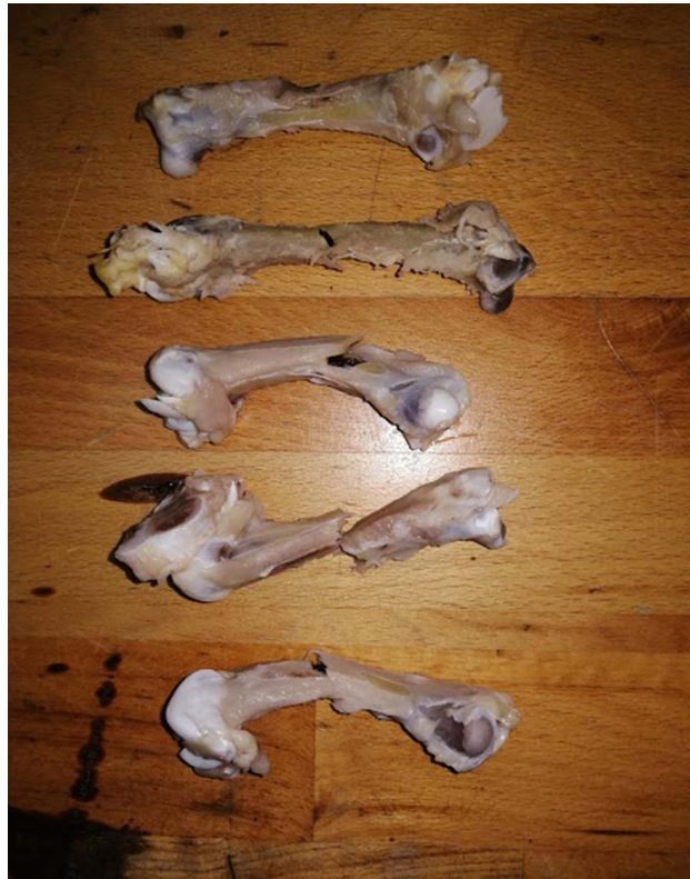
Şekil 5. Tavuk femur kemiği eğme testi sonucundaki hasar durumları
