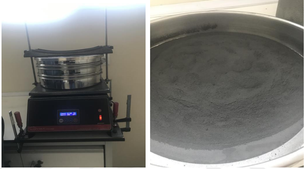
Resim 5.3. Deneysel çalışmalarda kullanılan 25 \mu boyutlarındaki ferrobor tozu
