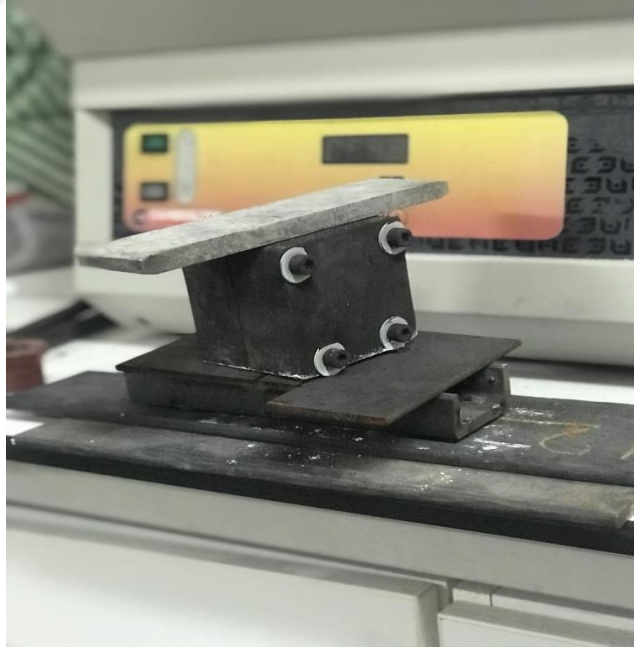
Resim 5.7. Döküm sonrası sođumaya bırakılan kokil kalıp
