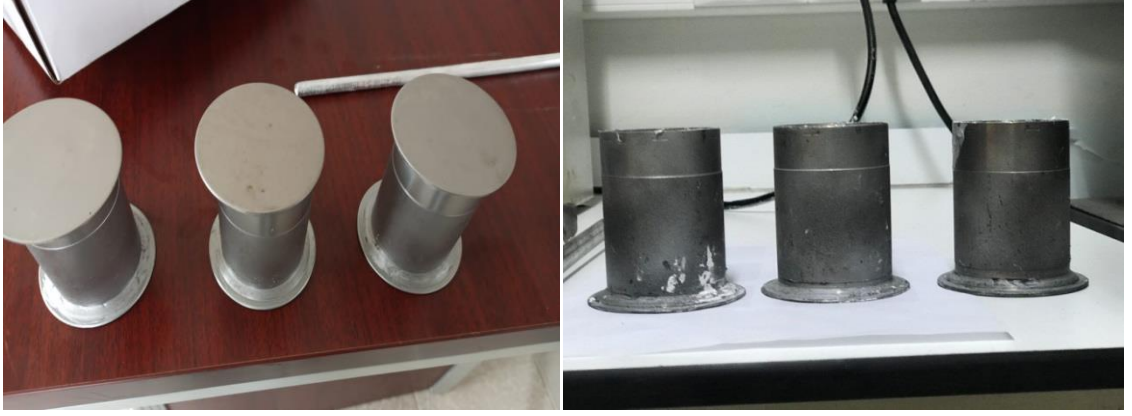
Resim 5.4. Deneyde kullanılan malzemelerin ergitildiği potalar
