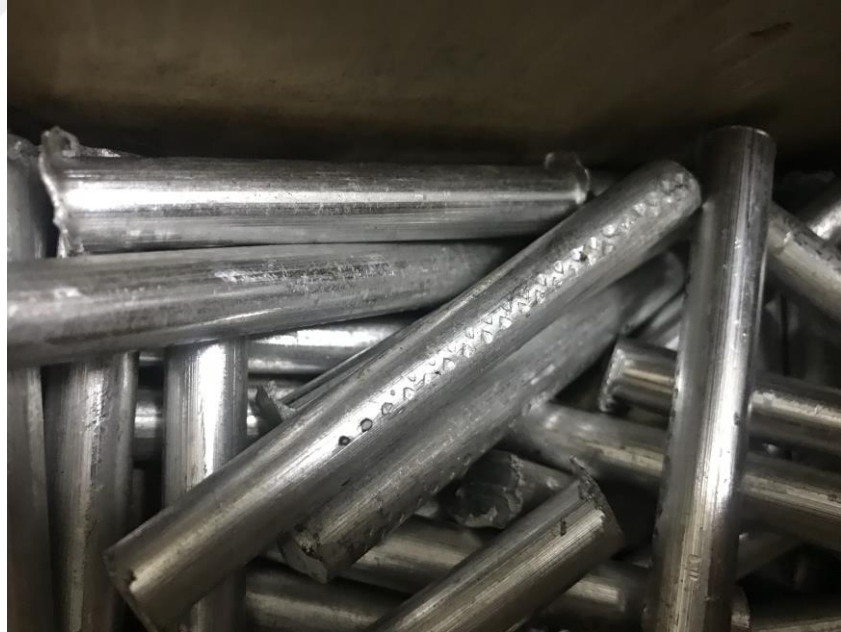
Resim 5.2. Deneysel çalışmalarda kullanılan Al-Ti-B katkı malzemesinin döküm öncesi hali
