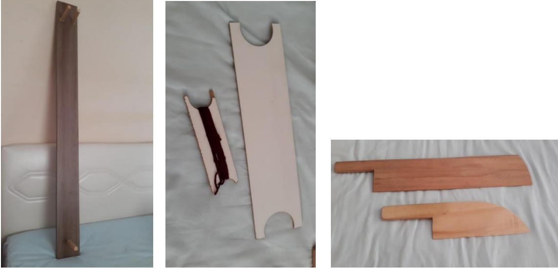
Görsel 4. Basit kolan dokuma tezgâhı ve parçaları
