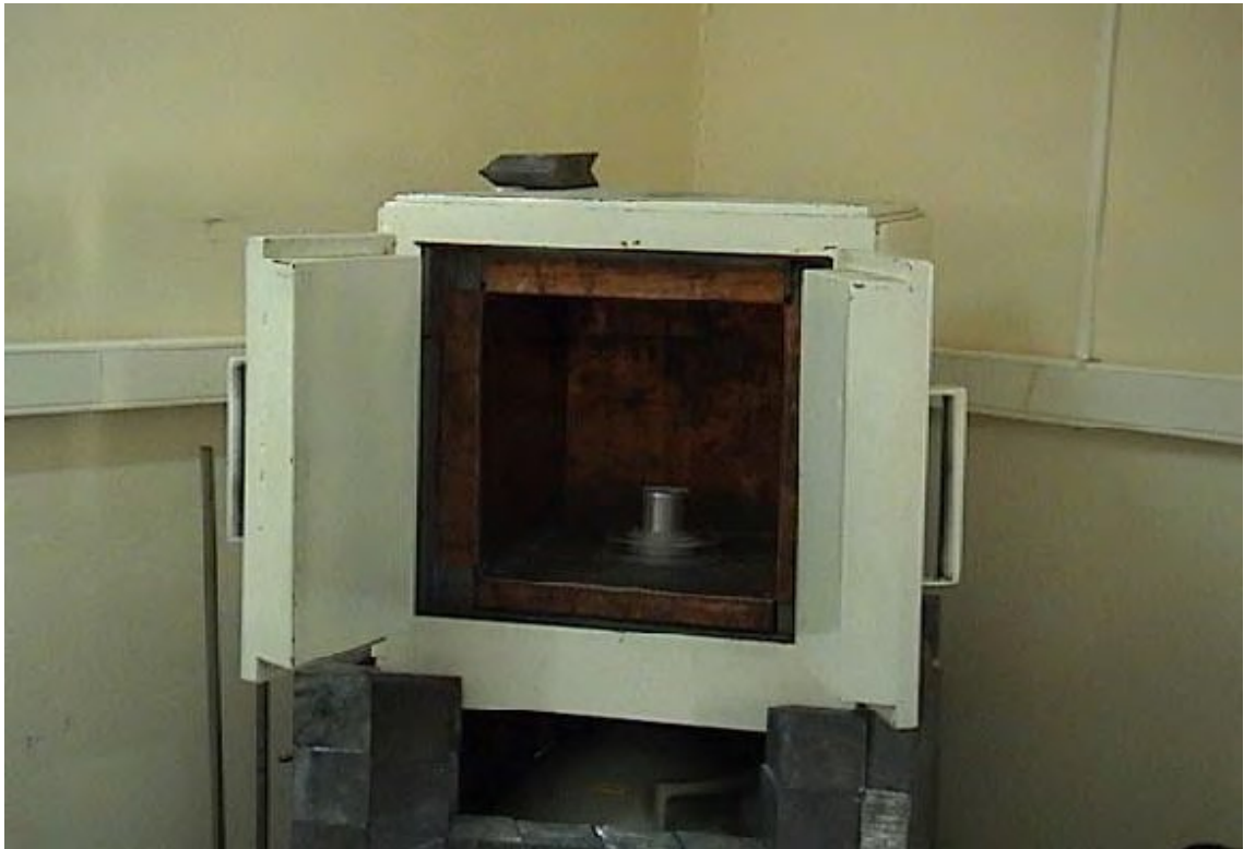
Şekil 3.2. Canberra marka HpGe gama spektrometrik analiz sistemi
