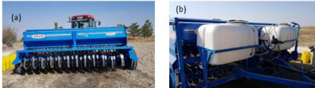
Şekil 2.1. Ekimle birlikte katı gübre uygulama mibzeri(a) ve sıvı gübre (b) uygulama makinesi
