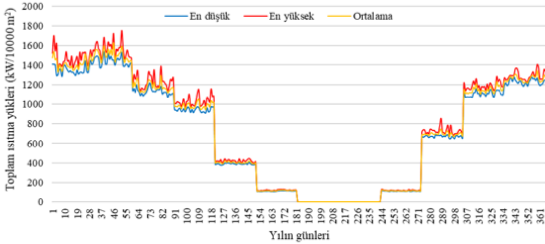
Şekil 3.7. Serada Toplam Isıtma Yüklerinin Yıllık Değişimi (İç sıcaklık 12 °C)
