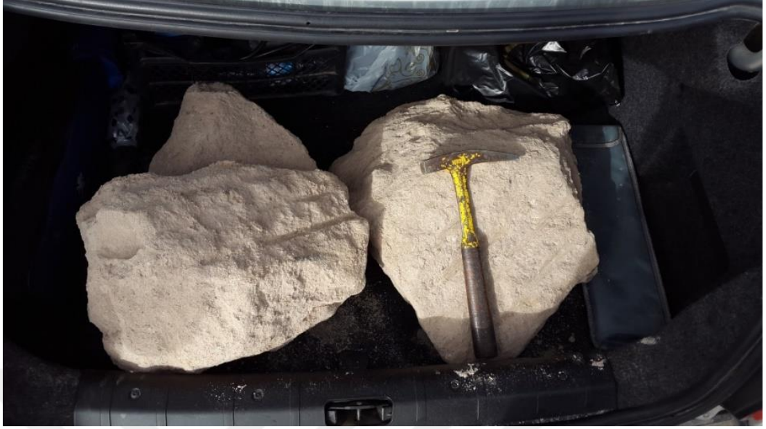
Resim 3.2 Yer altı depolarından laboratuvar alıřmaları iin alınan blok numunler
