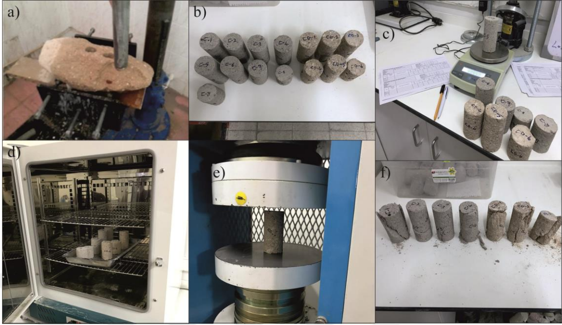
Resim 3.3 a) Analiz için kesilen blok numuneler, b) Analiz için hazırlanmış karot numuneleri, c) Doğal, doymun ve kuru ağırlıklarının ölçümü, d) Etüvde kurutulma işlemi, e) Tek eksenli sıkışma testi, f) Sıkışma sonucu yenilmeye uğramış olan numuneler
