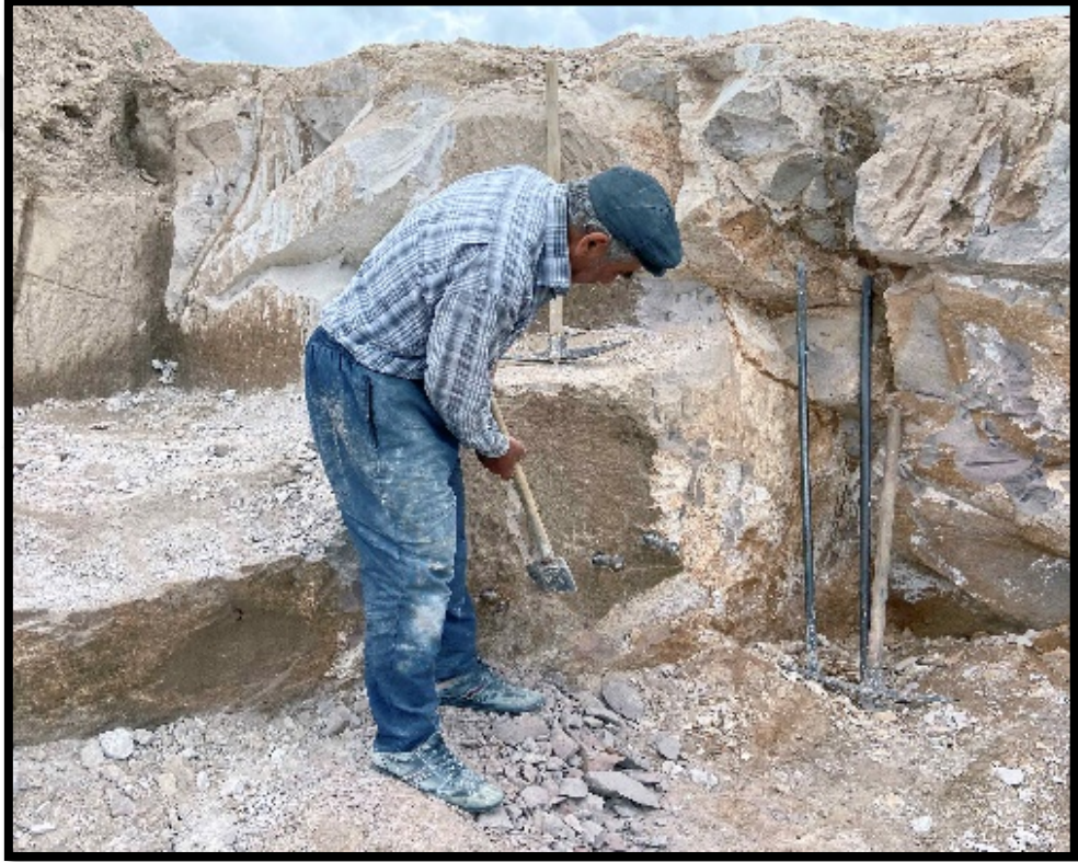
Görsel 4.5: Kaya Yüzeyine Balyoz ile Çivi Çakılma İşlemi
