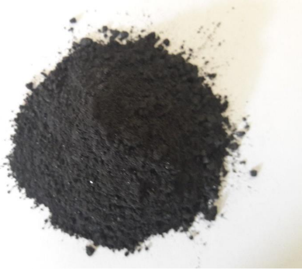
Şekil 3.2. Takviye malzemesi olarak kullanılan nano boyutlu B 4 C tozu makro fotoğrafı
