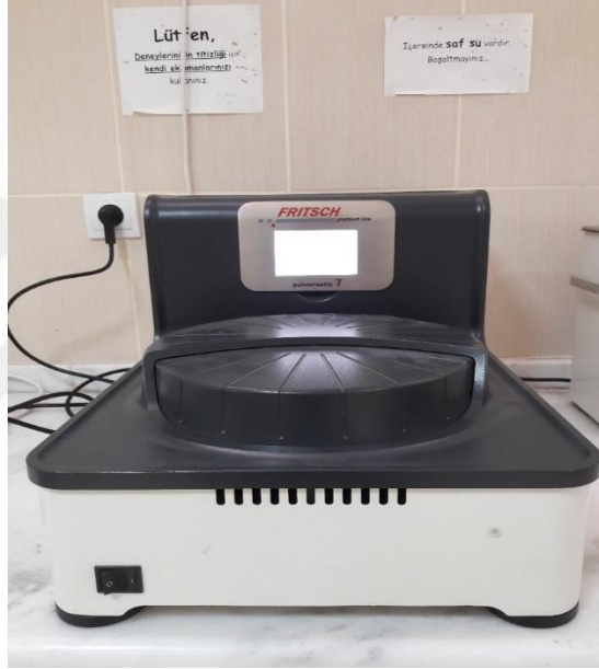
Şekil 3.4. Mekanik alaşımlama ve toz öğütme prosesinde kullanılan öğütücü
