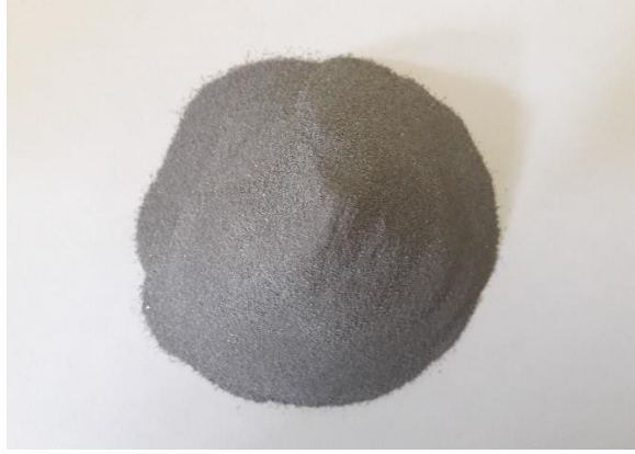
Şekil 3.1. Matris malzemesi olarak kullanılan Etial 141 alüminyum alaşımı tozu
