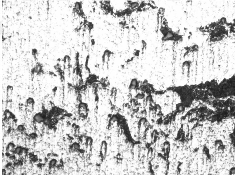
Şekil 4.4. %15 Nano B 4 C Takviyeli Al Kompozitin Optik Mikroyapı Fotoğrafi
