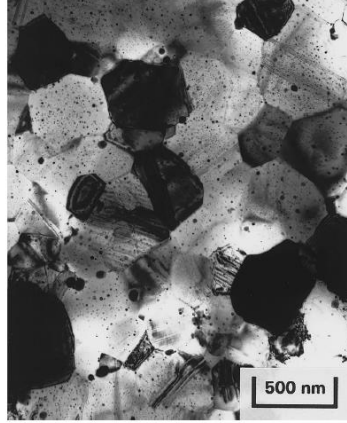
Şekil 2.28. \alpha_2 -TiAl alaşımı içerisinde düzgün bir şekilde dağılmış olan Er_2O_3 partiküllerinin SEM’de çekilmiş görüntüsü [31].
