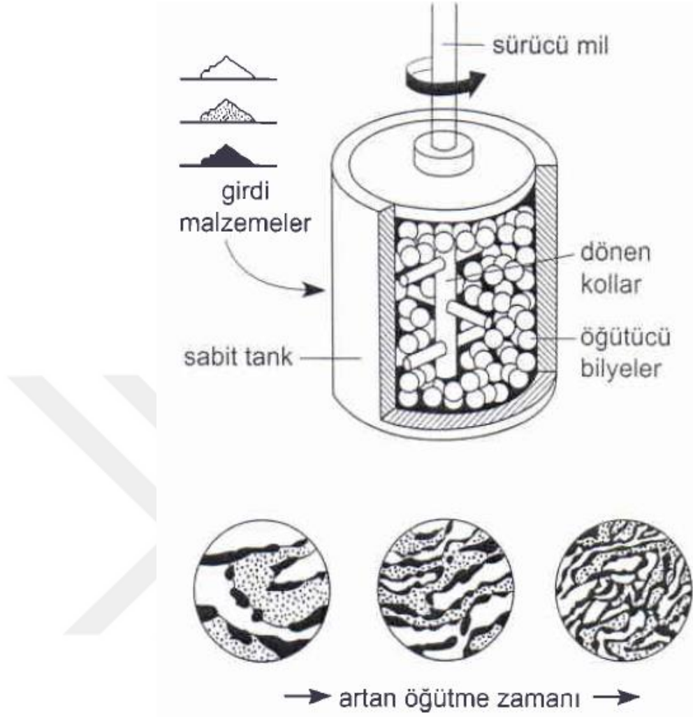
Şekil 2.23. Mekanik alaşımlamanın şematik gösterimi [27].
