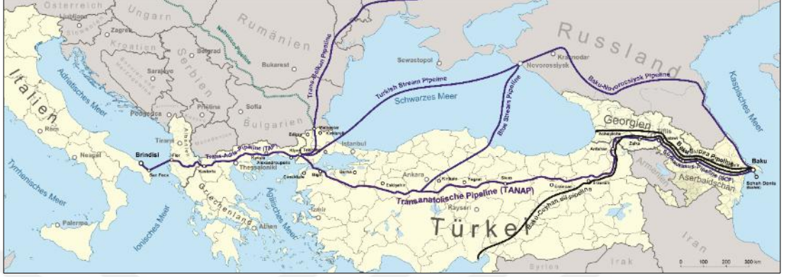
Şekil 3.11. BTE-TANAP-TAP Doğalgaz Boru Hattı Sistemi
