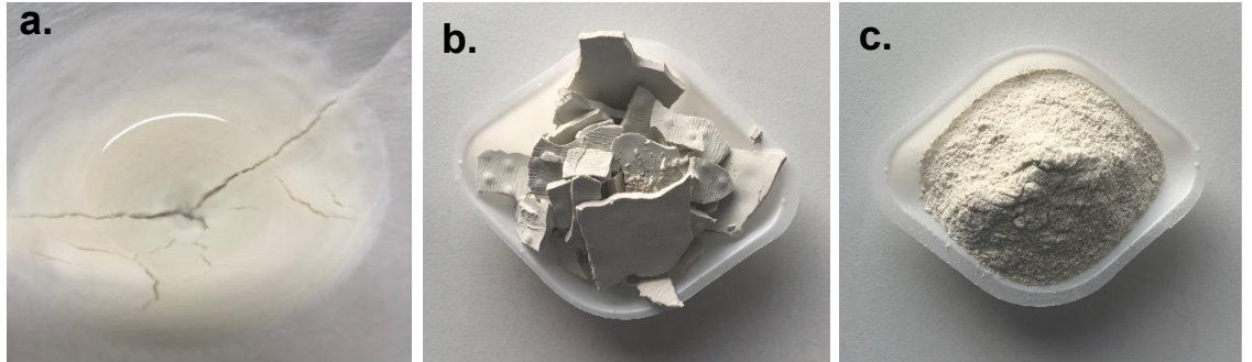
Şekil 3.2. Sentez Aşamaları: a. Klinoptilolit katkıli hidroksiapatit filtrasyon sonrası kremi formdadır; b. Klinoptilolit katkıli hidroksiapatit kurutma sonrası katı formdadır; c. Klinoptilolit katkıli hidroksiapatit öğütme sonrası toz formdadır.
