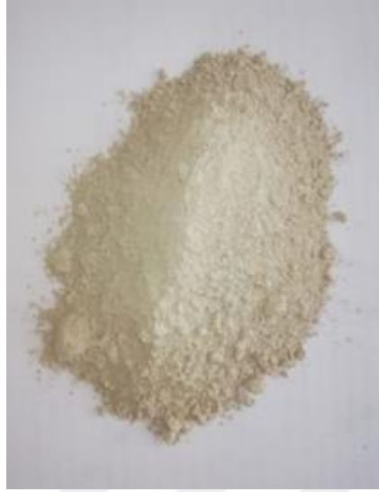
Şekil 4.1. Atık andezit tozunun görünümü
