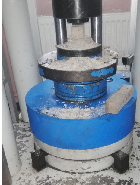
Şekil 4.8. Basınç dayanımı deneyi
