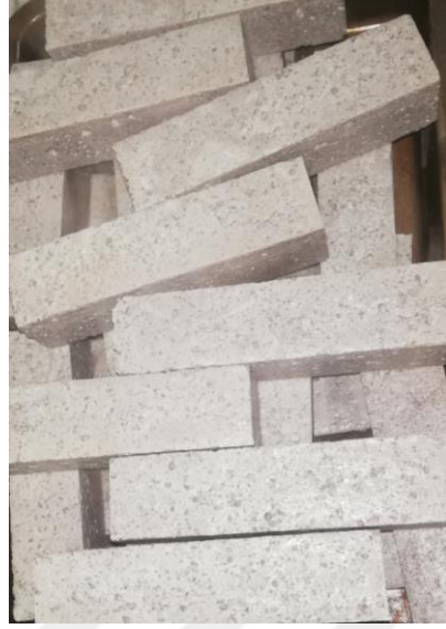
Şekil 4.10. Yüksek sıcaklık etkisi sonrası harçların görünümü
