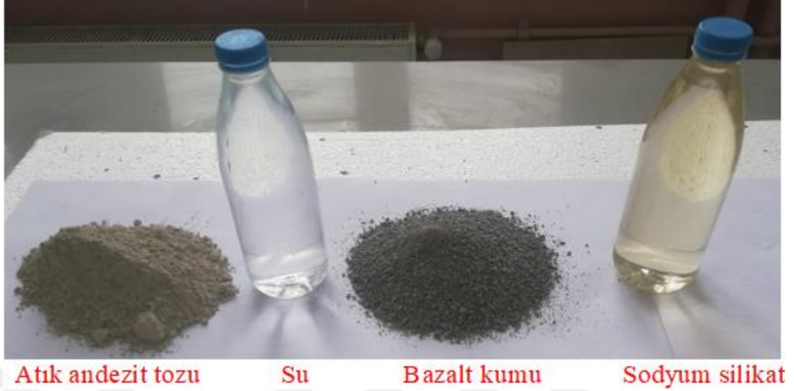
Şekil 4.5. Harç karışımlarında kullanılan malzemelerin birlikte görünümü
