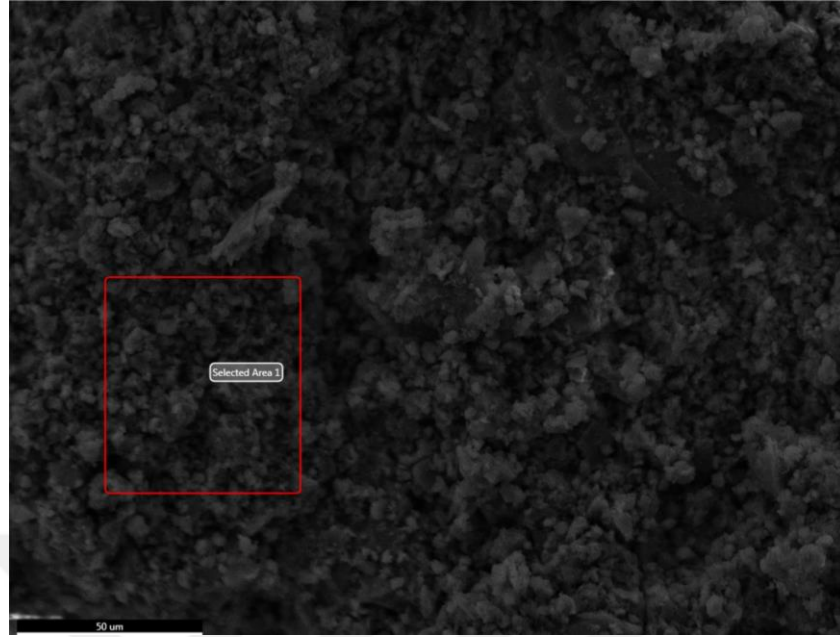
Şekil 5.51. 400 °C etkisi sonrası yavaşça havada soğutulan geopolimer harçların EDX analizinin alındığı alanın görünümü
