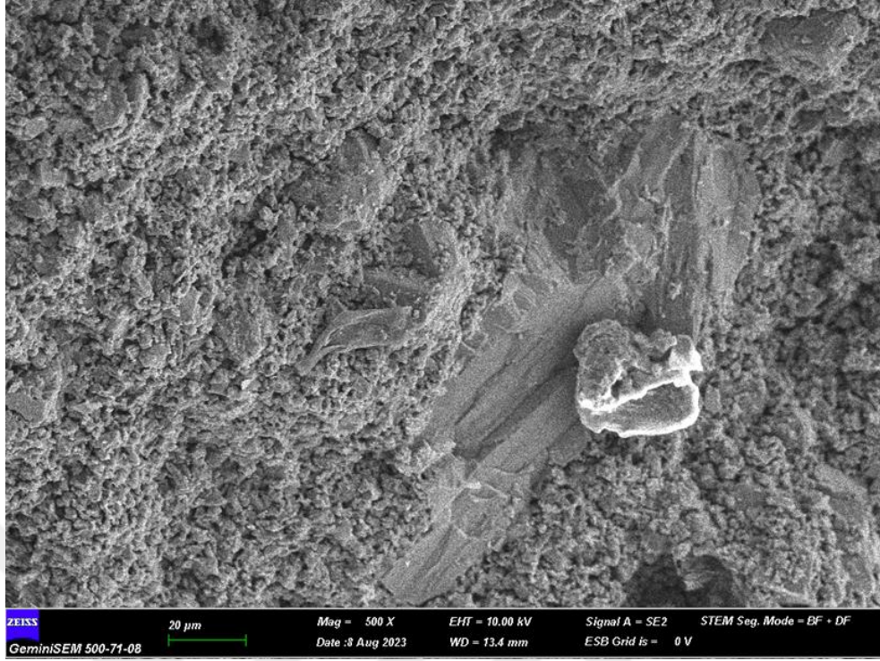
Şekil 5.23. 400 °C'ye maruz bırakıldıktan sonra suda soğutulan geopolimer harçların SEM görüntüsü (500X)
