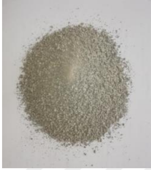
Şekil 4.4. Bazalt kumunun görünümü
