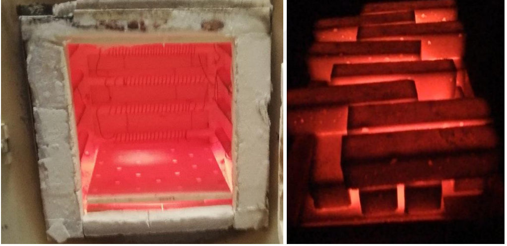
Şekil 4.9. Yüksek sıcaklık fırını
