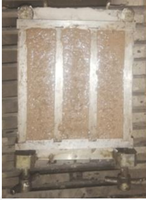
Şekil 4.6. Geopolimer harçların harç kalıbında taze haldeki görünümü
