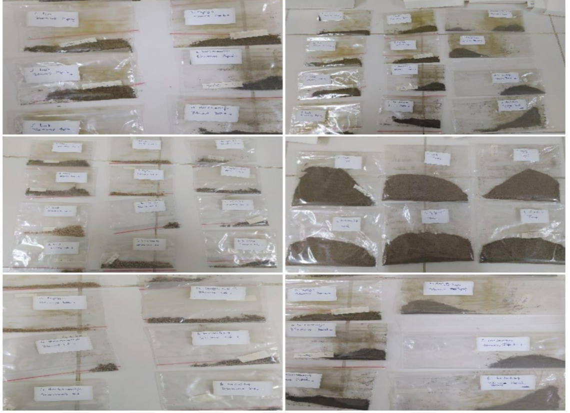
Şekil 3.3. Toplanan örneklerin (gövde, yaprak, kök ve toprak) kurutulduktan sonra paketlenmiş ve etiketlenmiş hali
