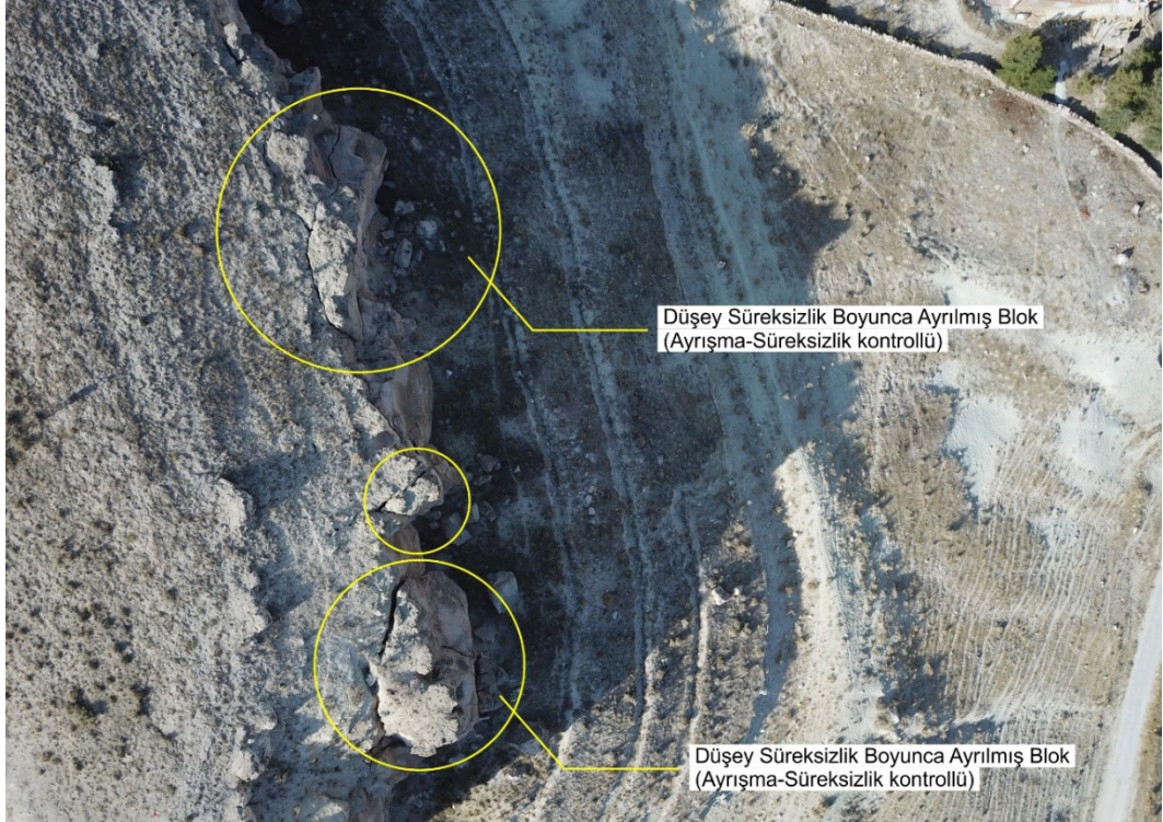
Şekil 4.8. Ana kayadan süreksizlik boyunca ayrılmış bloklar
