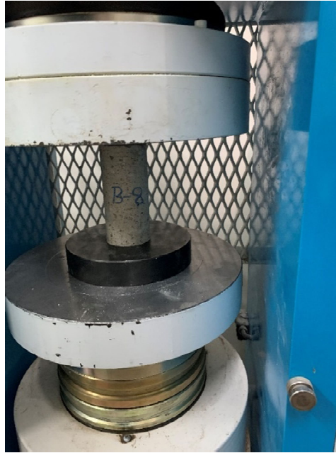
Şekil 3.4. Tek Eksenli sıkışma dayanımı deneyinin görünümü
