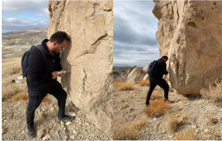
Şekil 3.1. Arazide Schmidt çekici ve İğne penetrometresi deneyinin uygulanması
