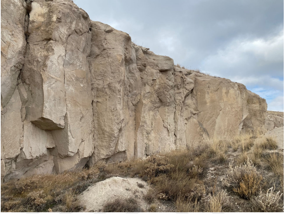
Şekil 4.12. Arazide düşey soğuma çatlakları ve süreksizliklerin genel görünümü
